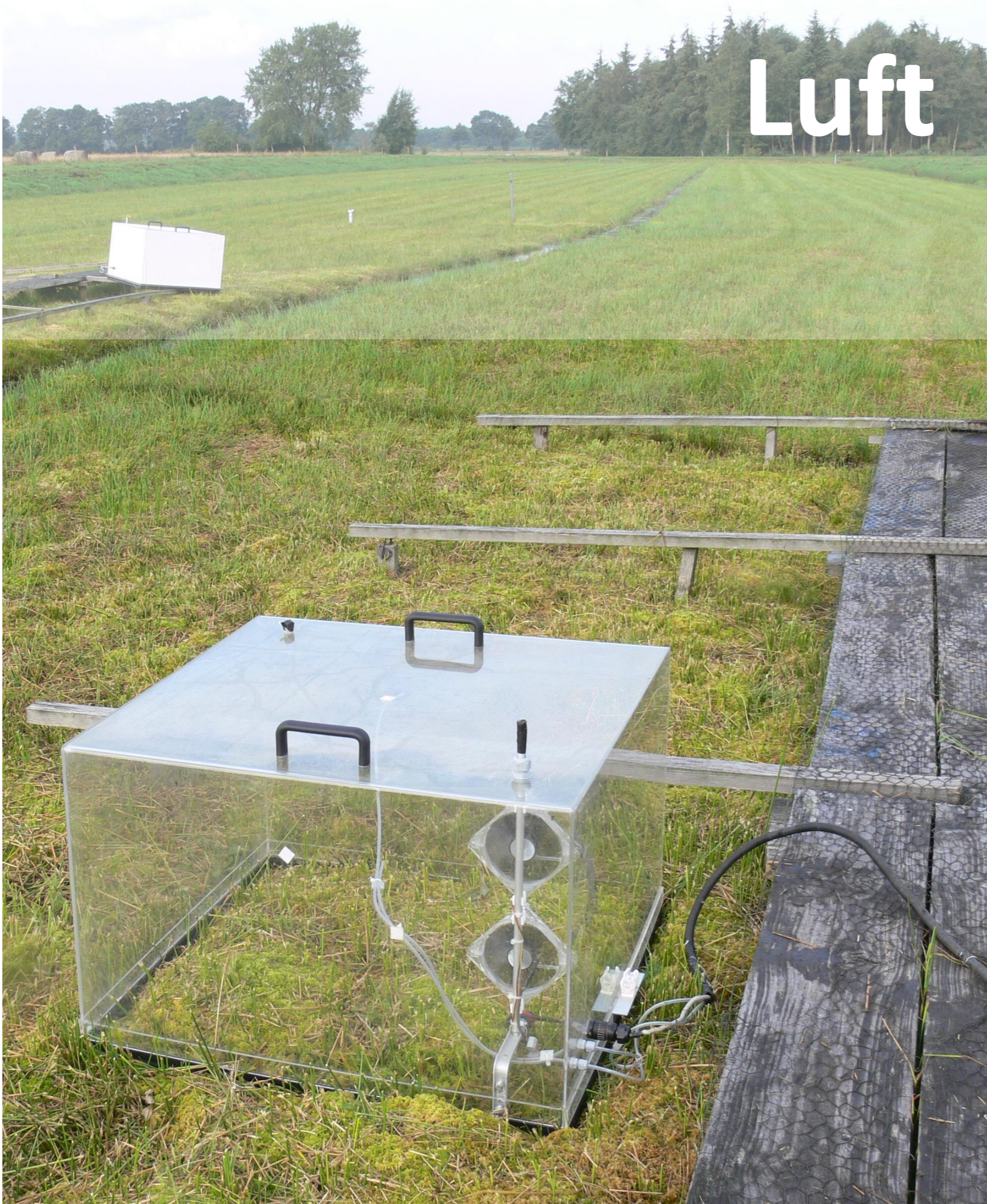
Der Treibhausgaswechsel wird mit Kammern gemessen.
